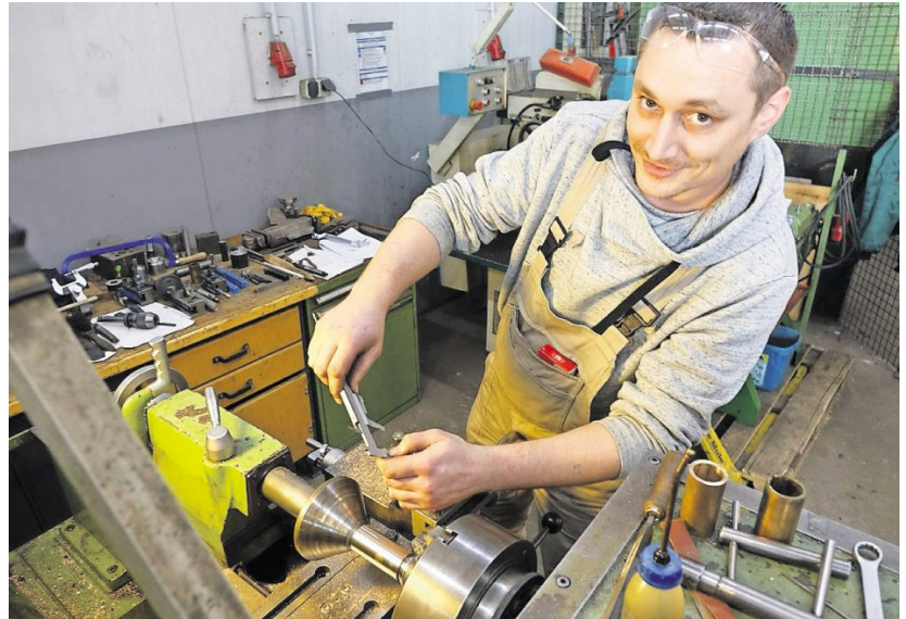
Der 35-jährige Christian Künkele aus Cuxhaven dreht an der gleichnamigen Maschine eine Lagerbuchse. Solche Aufgaben gehören zum Inhalt seiner Umschulung zur Fachkraft Metalltechnik. Fotos: May
